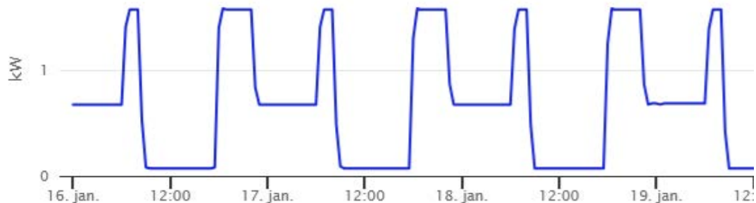
Éclairage avec baisse d'éclairement automatique
